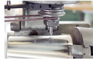
Für das Gravurverfahren spricht Ästhetik, Sicherheit und die Möglichkeit auf Einzelanfertigungen. CNC-gesteuerte Graviermaschinen fertigen auf den Materialien Aluminium, Edelstahl und Kunststoff maß genau und ermöglichen kurzfristig Massengravuren, Varianten, Stahlstempel und Einzelstücke.
